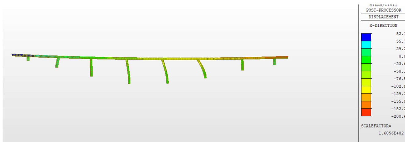
Obr. Výsledné vodorovné deformácie od návrhovej kombinácie zaťaženia – MSU zima gr1a
